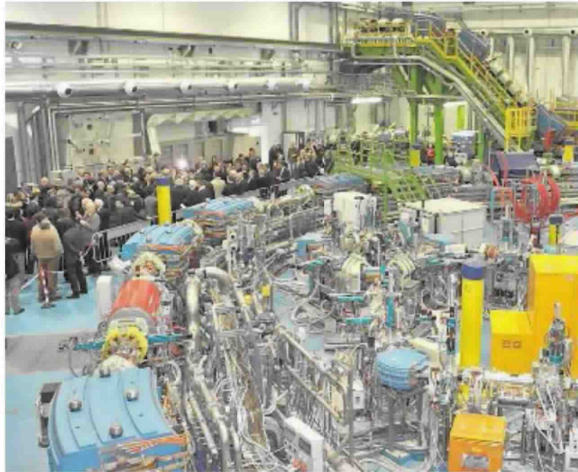
ALTISSIMA TECNOLOGIA L'acceleratore del Cnao, simile a quello del Cern di Ginevra ma più piccolo: ottanta metri di circonferenza
