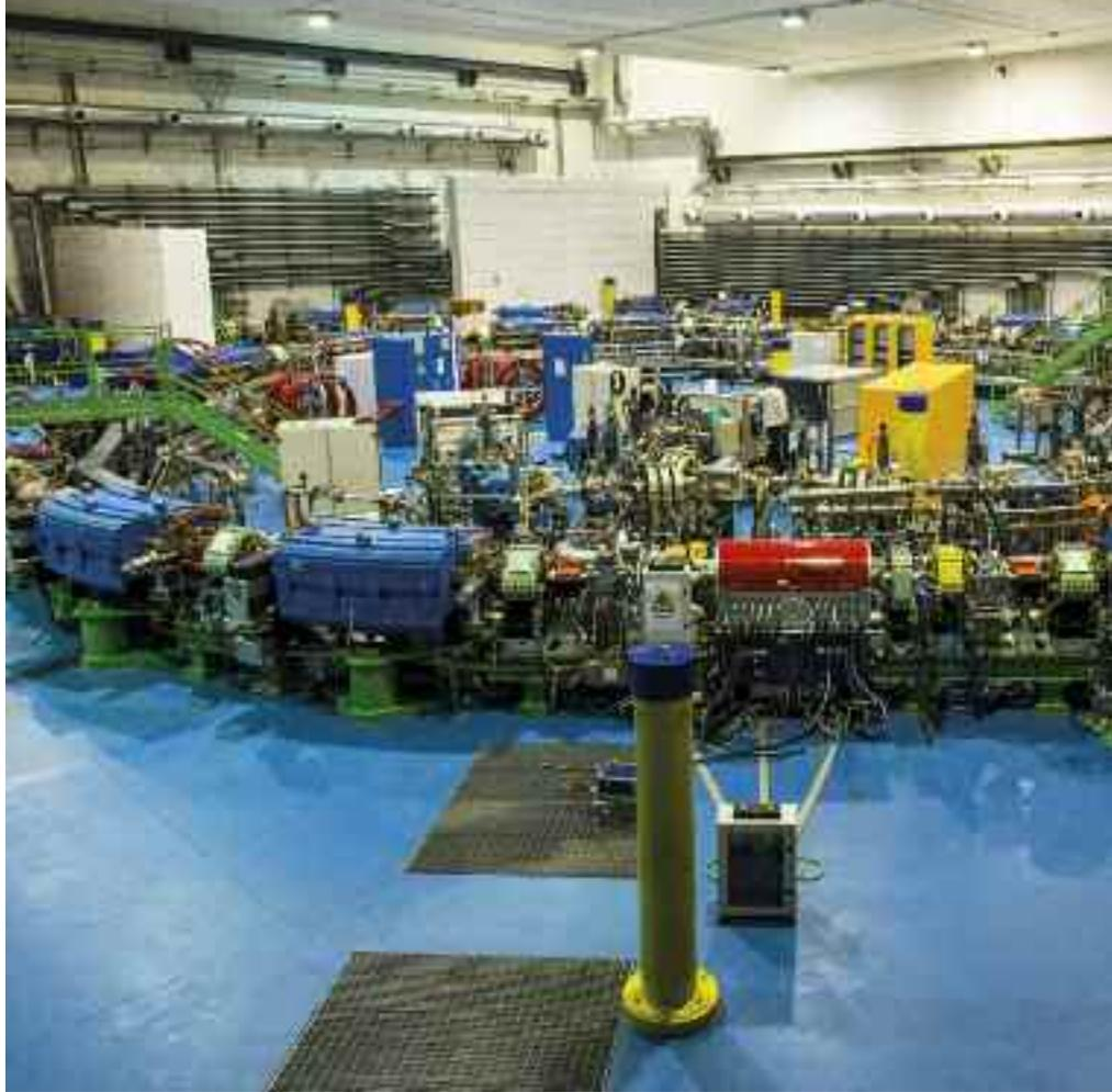
*Il Cnao di Pavia è uno dei centri più avanzati al mondo nella cura dei tumori. Applica l'adroterapia, ovvero una cura a base di protoni e ioni carbonio, grazie ad un acceleratore di particelle, il sincrotrone, gioiello della tecnologia*
